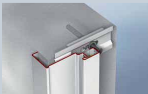
Завинтете профил 1 на ъгловата каса към преградната стена
