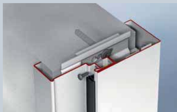
Завинтете профил 2 на ъгловата каса за профил 1 през жлеба за уплътнението и го покрийте с уплътнението на вратата
